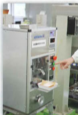
全自動単発式打錠機によるラムネ菓子の試作
