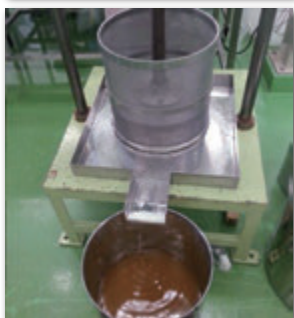
手廻し式搾汁機による酢の搾汁
