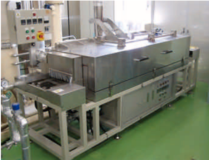
図1.当センターに導入された過熱水蒸気処理装置
