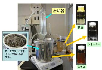
図. ローズマリーの水蒸気蒸留装置(北見工業大学社会連携推進センター)
