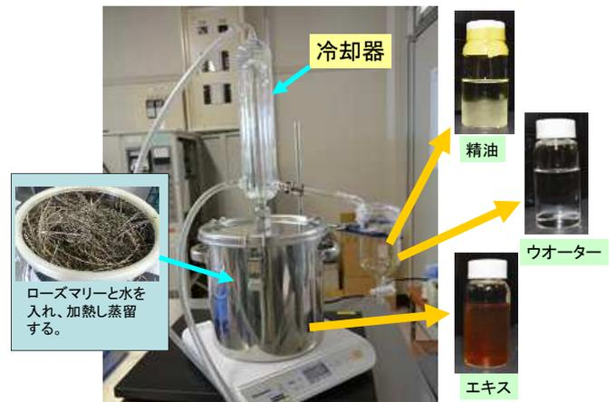
図. ローズマリーの水蒸気蒸留装置(北見工業大学社会連携推進センター)
