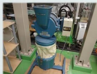
乾燥物を粉碎する機械です。スクリーンを変えることで粉碎物のサイズを調整できます。
