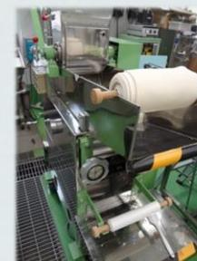
生地を、回転ローラーで段階的に薄く延ばして麺帯を作り、この麺帯を付属の切刃で細く切ること、うどんやラーメンを作れます。
