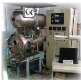
長期常温保存を可能にするため、100℃～120℃で加熱殺菌します。缶詰め、瓶詰め、レトルトパウチ(カレーなど)の試作に利用できます。
