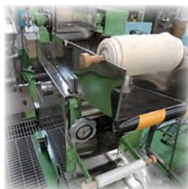
生地を、回転ローラーで段階的に薄く延ばして麺帯を作り、この麺帯を付属の切刃で細く切ることで、うどんやラーメンを作る機械です。
