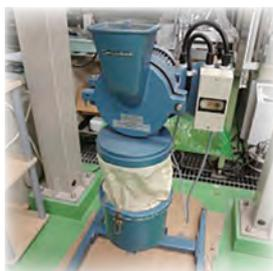
乾燥物を粉砕する機械です。スクリーンを変えることで粉砕物のサイズを調整できます。
