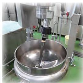
加熱しながら掻き採り羽根を回転させることで、釜の底面や側面の掻き採りと混合を行います。野菜のソテーやスープなどの試作に利用できます。
