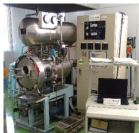
長期常温保存を可能にするため、100℃～120℃で加熱殺菌します。缶詰め、瓶詰め、レトルトパウチ(カレーなど)の試作に利用できます。
