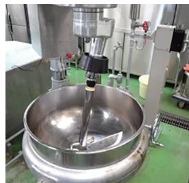
加熱しながら掻き採り羽根を回転させることで、釜の底面や側面の掻き採りと混合を行います。野菜のソテーやスープなどの試作に利用できます。
