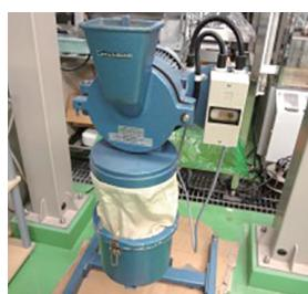
乾燥物を粉碎する機械です。スクリーンを変えることで粉碎物のサイズを調整できます。
