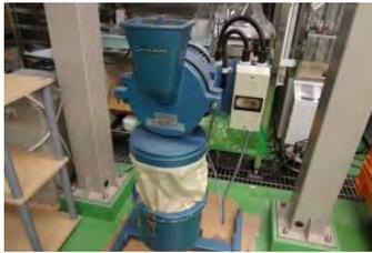
乾燥物を粉碎する機械です。スクリーンを変えることで、粉碎物のサイズを調整できます。
