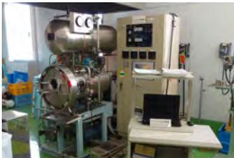
長期常温保存を可能にするため100℃～120℃で加熱殺菌します。缶詰、瓶詰、レトルトパウチの試作に利用できます。
