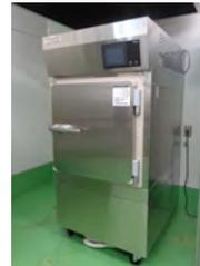
湿度の高い冷気を循環させることで、食品を短時間で高品質に冷凍させる装置です。
