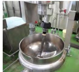
加熱しながら掻き採り羽根を回転させることで、釜の底面や側面の掻き採りや混合を行います。野菜のソーテーやスープ等の試作に利用できます。
